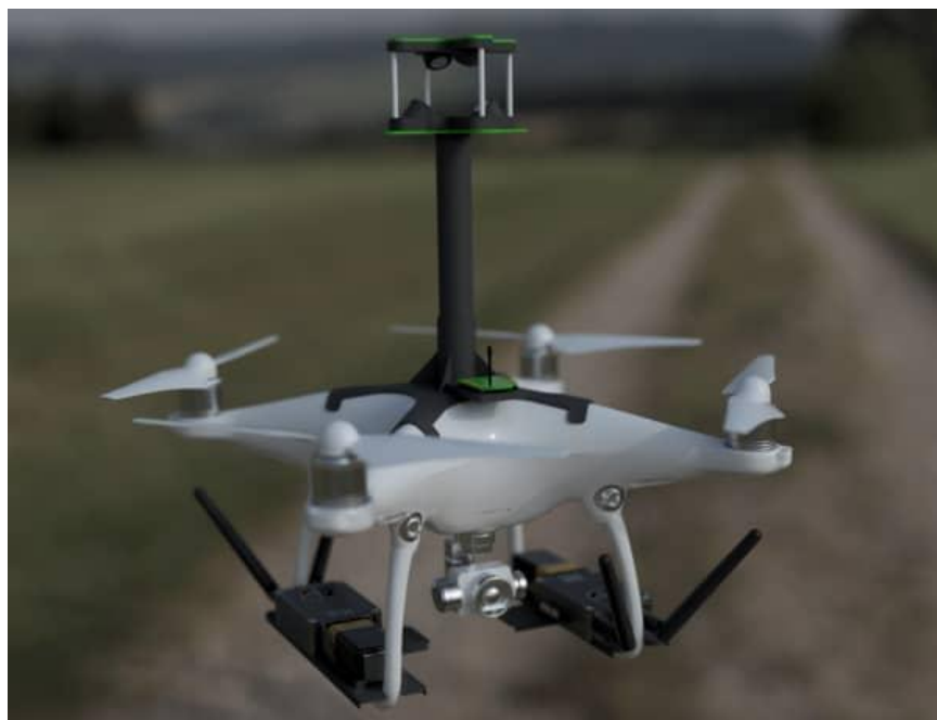
Εικόνα 3.2: Αισθητήρας καιρού ενσωματωμένος σε κατασκευή UAV εν όψει ατμοσφαιρικών και μετεωρολογικών μελετών [37]
