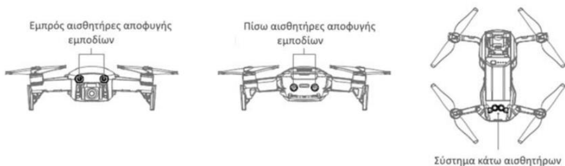
Εικόνα 2.8: Αισθητήρες αποφυγής εμποδίων του DJI Mavic Air
