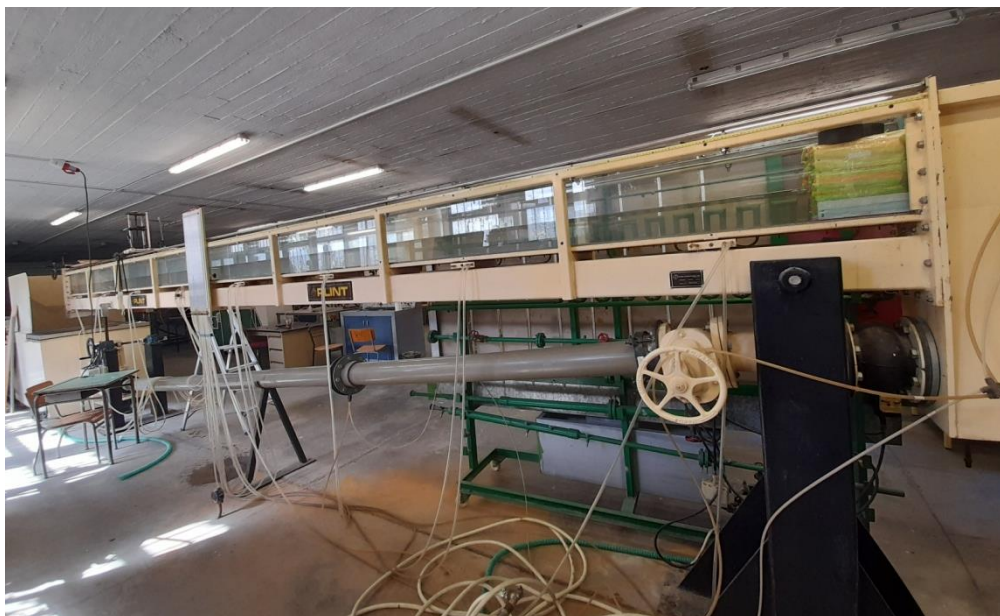
Εικόνα 3.1: Ανοικτός αγωγός εργαστηρίου.
