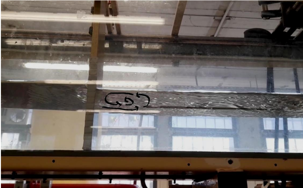
Εικόνα 5.1: Στροβιλισμός νερού κατόντη του προβόλου.
