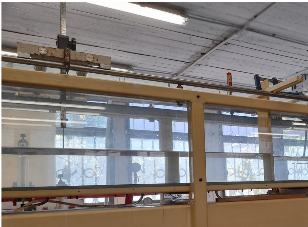
Εικόνα 4.5: Σταθμήμετρο και ξύλινο ομοίωμα.
