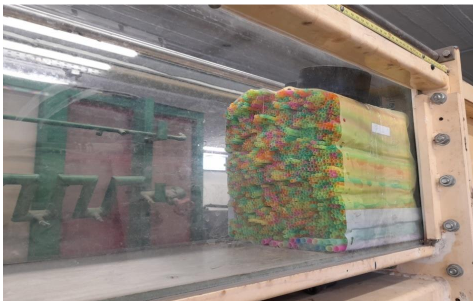
Εικόνα 3.2: Κατασκευή ομοιομορφισμού της ροής.
