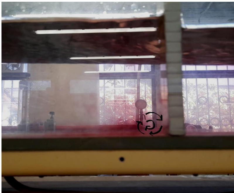
Εικόνα 5.2: Στροβιλισμός νερού ανάντη του προβόλου.
