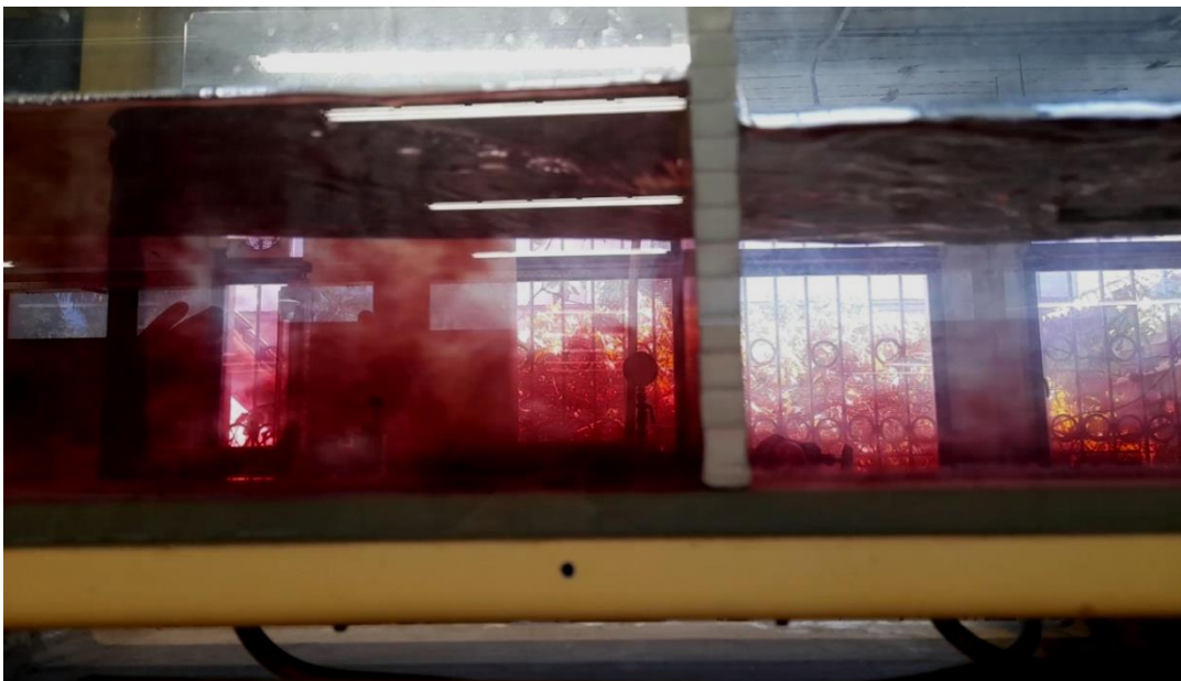
Εικόνα 4.6: Συμπεριφορά ιχνηθέτη εντός του πεδίου ροής.
