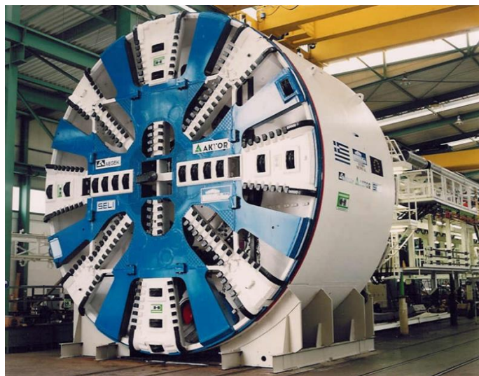
Εικόνα 1.7: Μηχανή διάνοιξης σε σκληρό βράχο (Hard Rock)
