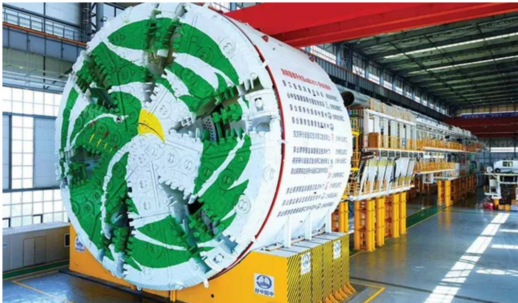
Εικόνα 1.3: Μηχανή υγρής υποστήριξης
