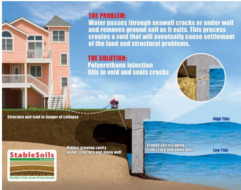
Εικόνα 3.16: Περίπτωση ενέματος σε νερό
