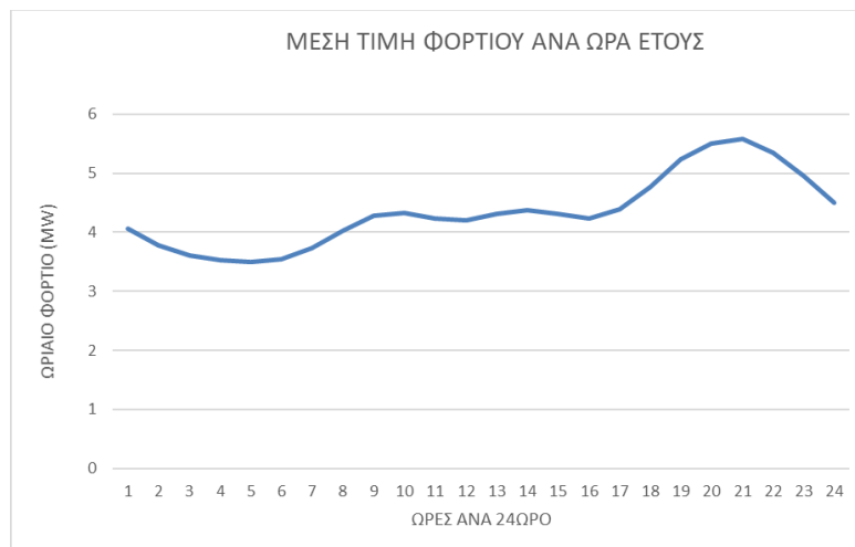
Διάγραμμα (4.1.b) Διάγραμμα που δείχνει το μέσο ημερήσιο φορτίο σε (MW) ανά ώρες ημέρας για μία περιοχή[62]
