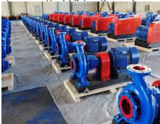
Εικόνα (2.3.a) Φωτογραφία από εργοστάσιο κατασκευής φυγοκεντρικών ακτινικών αντλιών[21]
