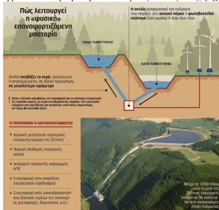
Εικόνα (2.1.a) Ενδεικτικό παράδειγμα αντλιοσταμείωσης σε υβριδικό σταθμό και απεικόνιση πραγματικού [22]
