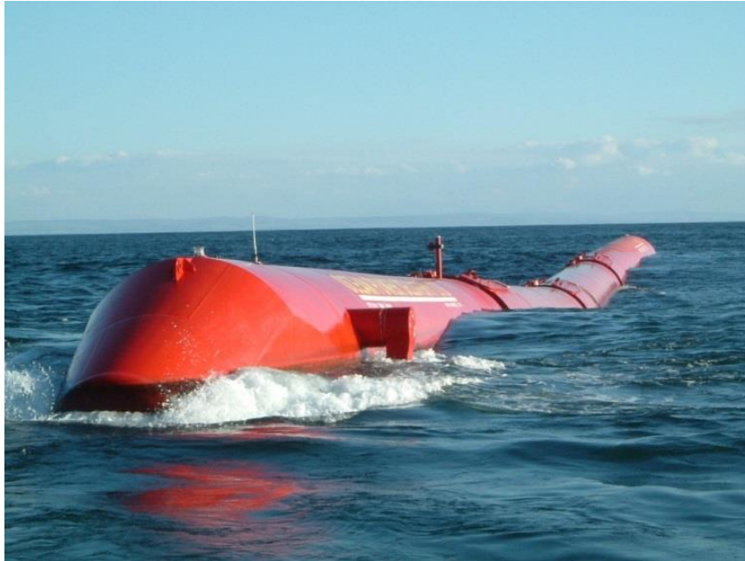
Εικόνα Ε5: Σύστημα παραγωγής ηλεκτρικής ενέργειας από κυματισμό με το όνομα Pelamis
