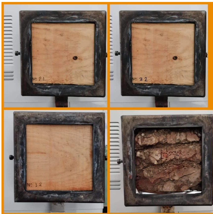
Εικόνα 19 Τοποθέτηση δοκιμίων στην βάση - έλεγχος διαστάσεων.
