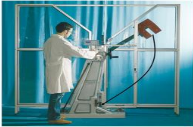
Εικόνα 12: Φόρτιση ξύλου σε κρούση. (Πηγή: Μπιρμπίλης 2012)
