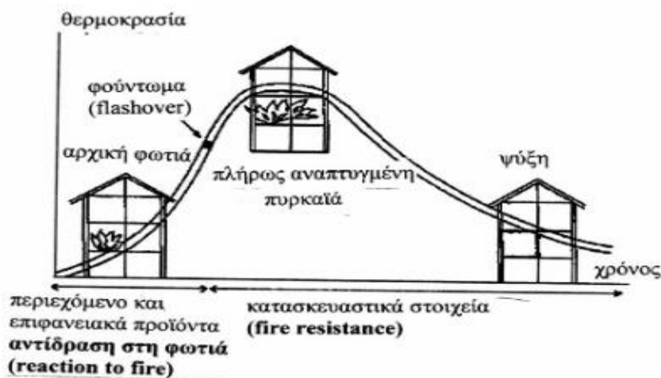
Εικόνα 3: Στάδια της πυρκαγιάς σε κτίρια. . (Πηγή: Τεχνικό Επιμελητήριο Ελλάδας)
