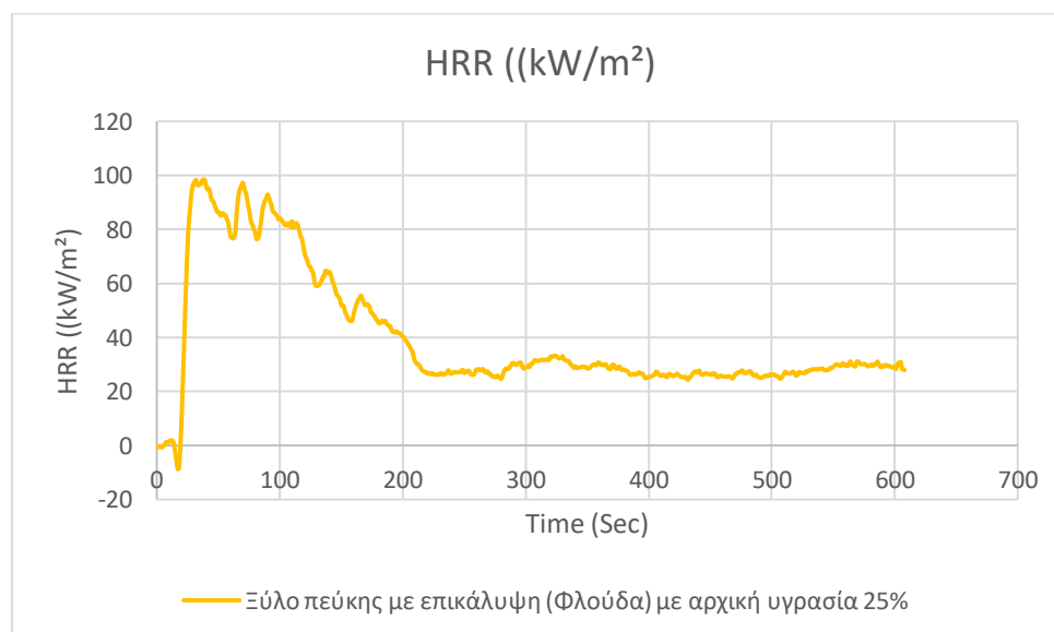
Εικόνα 25 Ρυθμός έκλυσης θερμότητας για ξύλο Πεύκης με επικάλυψη (Φλούδα) με αρχική υγρασία 25%.
