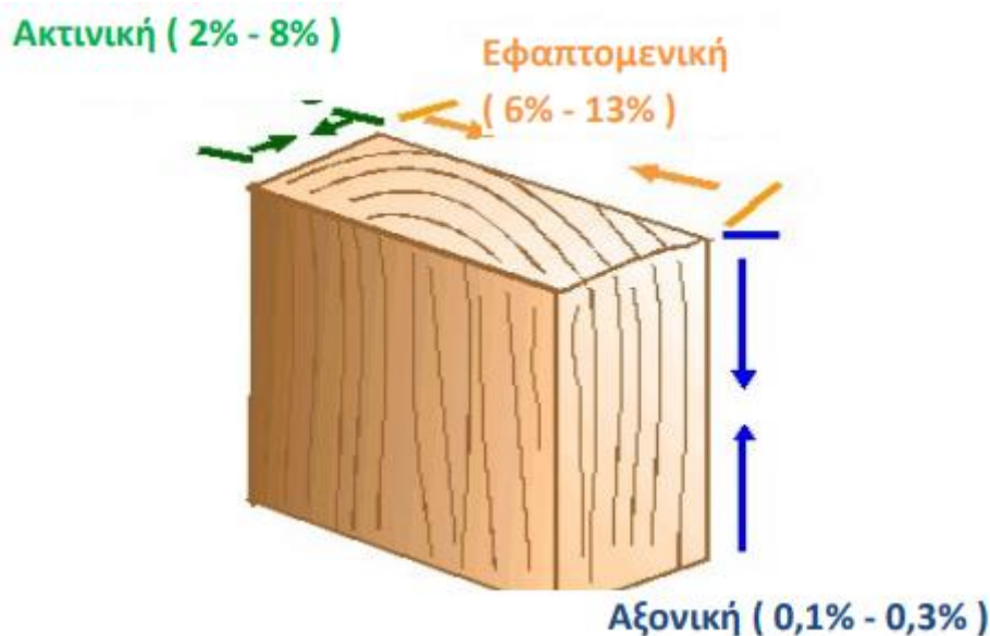
Σχημα 1: Διαστασιακές μεταβολές του ξύλου στις 3 διαφορετικές διευθύνσεις. . (Πηγή: Μπιρμπίλης 2012)
