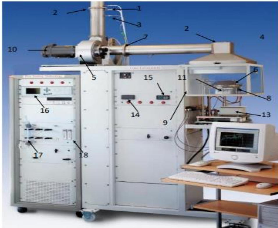
Εικόνα 15: Απεικόνιση Θερμιδόμετρου Κώνου της εταιρείας Fire Testing Technology (FTT UK).
