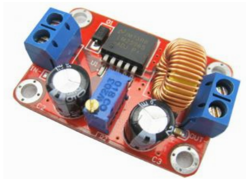
Εικόνα 4.35: Μετατροπέας DC-DC Step-Down [Πηγή]
