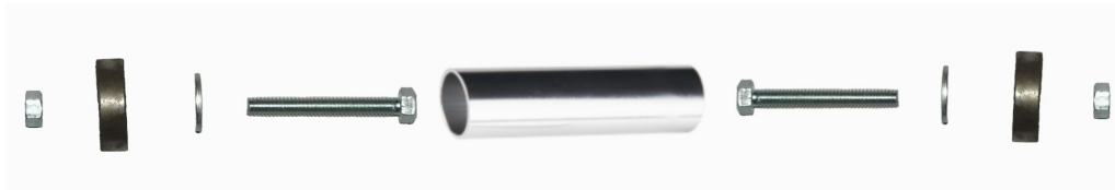
Εικόνα 4.58: Σχέδιο κατασκευής παθητικού roller ταινιόδρομου
