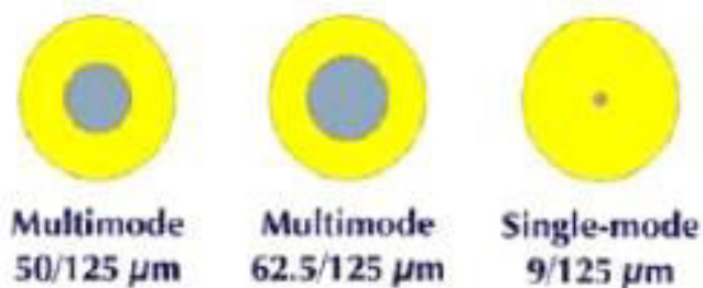
Εικόνα 2.2: Διατομές των οπτικών ινών μονότροπων και πολύτροπων.
