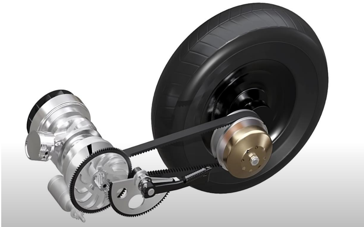
Εικόνα 1.5: Σύστημα μετάδοσης της κίνησης στον τροχό του σκούτερ
