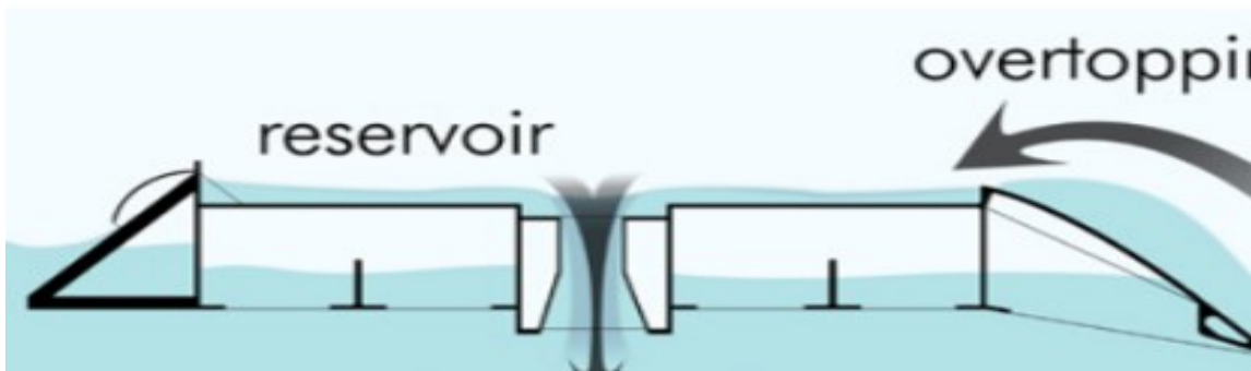
Εικόνα 2.23: Σχέδιο λειτουργίας του Wave Dragon WEC [47]
