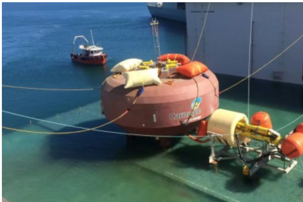
Εικόνα 2.14: WAB Carnegies CETO πριν την τοποθέτηση [38]
