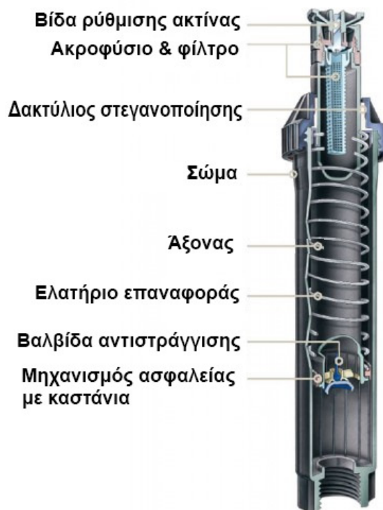
Εικόνα 14. Υπόγειος στατικός αυτοανυψούμενος εκτοξευτήρας
