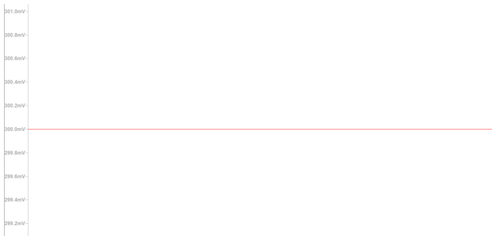
Εικόνα 4.40: Τάση στην έξοδο του μετατροπέα μας για σήμα εισόδου στα 1 Giga Hz.
