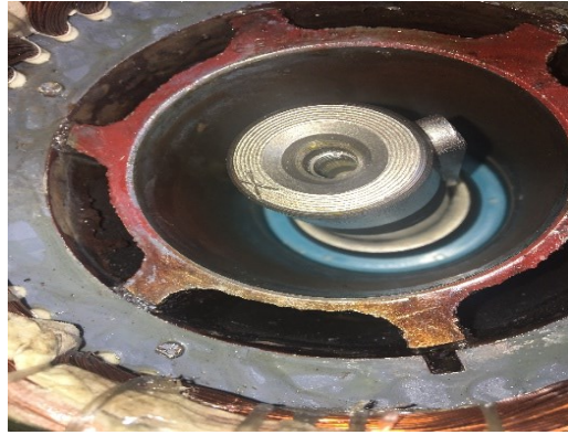
Εικόνα 2-7 Τσιμούχα άξονα ,παλιό και καινούρια
