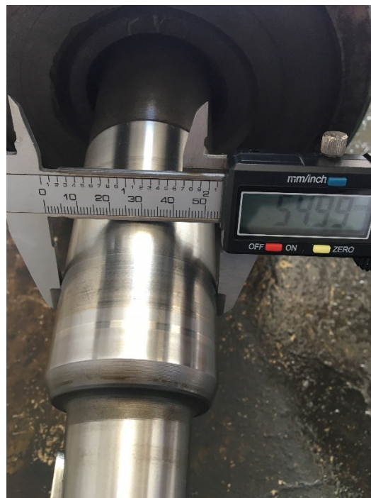
Εικόνα 2-6 Μέτρηση άξονα για την τοποθέτηση της σωστής τσιμούχας και καθάρισμα σε μηχανουργείο
