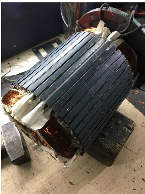
Εικόνα 2-8 Σημείο όπου έχει φθαρεί η περιέλιξη
