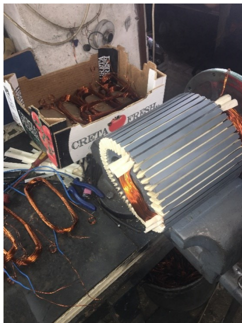
Εικόνα 2-8 Σημείο όπου έχει φθαρεί η περιέλιξη
