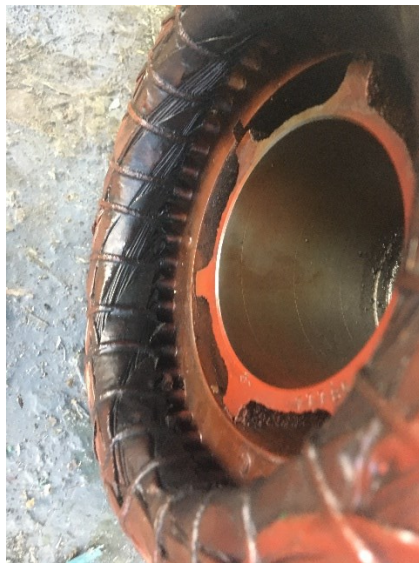
Εικόνα 2-8 Σημείο όπου έχει φθαρεί η περιέλιξη
