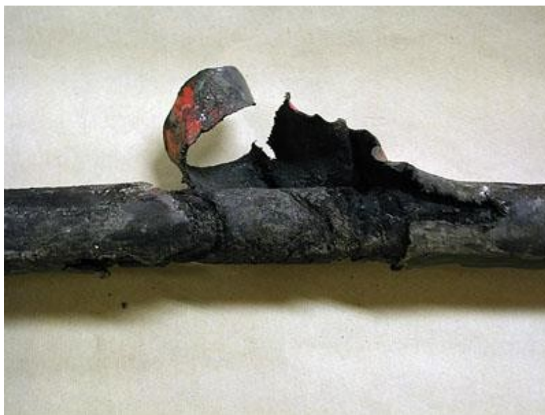
Εικόνα 1.9 Διάβρωση του μανδύα σε καλώδιο Μ.Τ [18]
