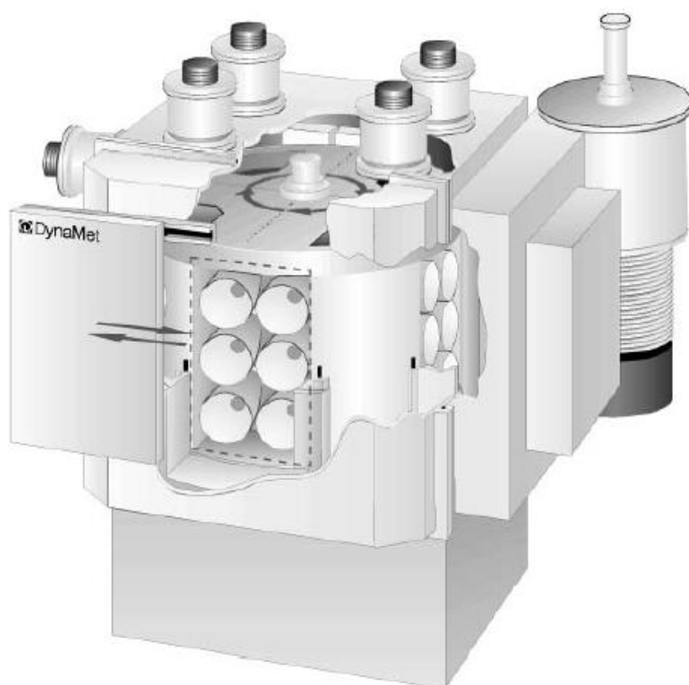
Σχήμα 5.5 Μονάδα επίστρωσης εξαρτημάτων με πολλούς θαλάμους [2].
