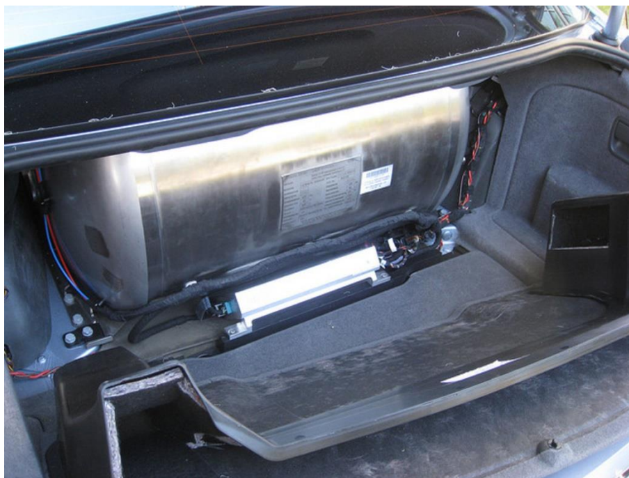
Εικόνα 27: Η δεξαμενή του υγρού υδρογόνου στον χώρο αποσκευών του αυτοκινήτου
