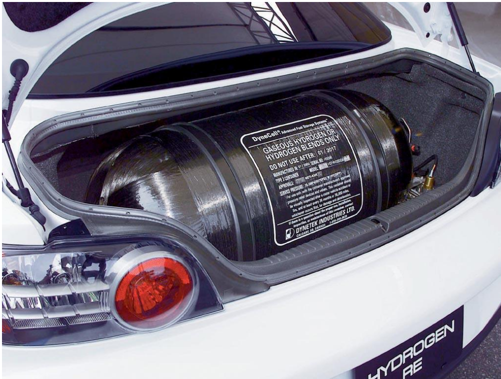
Εικόνα 21: Η δεξαμενή αποθήκευσης του καυσίμου υδρογόνου στον χώρο των αποσκευών
