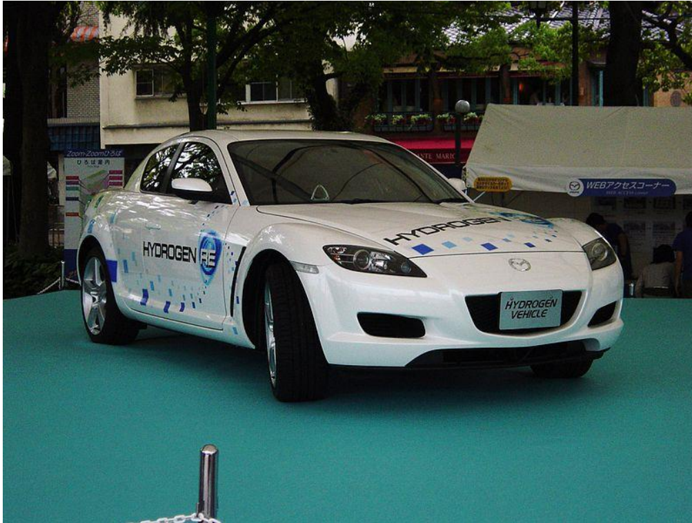
Εικόνα 20: Το μοντέλο RX-8 Renesis της αυτοκινητοβιομηχανίας Mazda, το πρώτο και μοναδικό περιστροφικό υβριδικό αυτοκίνητο υδρογόνου-βενζίνης στον κόσμο, που παρουσιάστηκε στο Τόκιο της Ιαπωνίας το 2003
