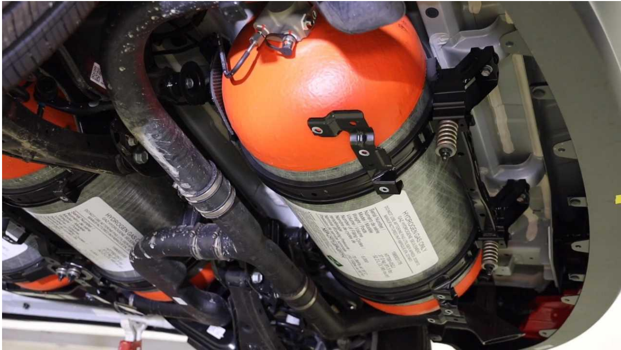
Εικόνα 33: Οι δεξαμενές αποθήκευσης του καυσίμου υδρογόνου, τοποθετημένες κάτω από τον χώρο αποσκευών και συγκρατημένες από το πλαίσιο(σασί) του αμαξώματος
