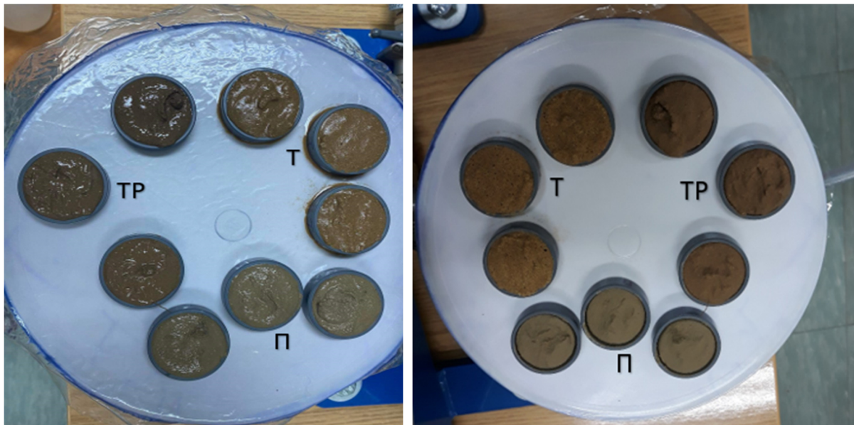
Εικόνα 8.14 Η εισαγωγή και η εξαγωγή των δειγμάτων στη τράπεζα πίεσης
