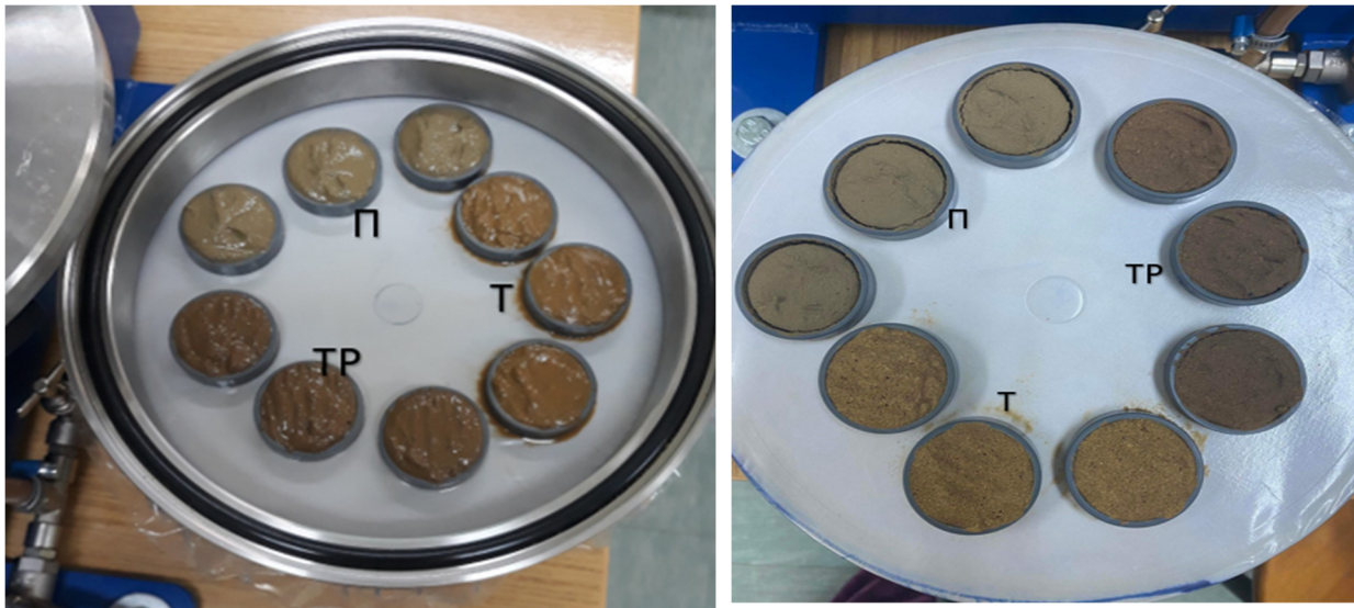
Εικόνα 8.13 Η εισαγωγή και η εξαγωγή των δειγμάτων στη τράπεζα πίεσης
