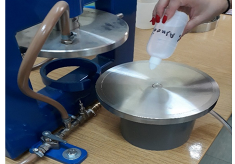
Εικόνα 5.16 Καθαρίζουμε την πλάκα βάσης με αλκοόλη
