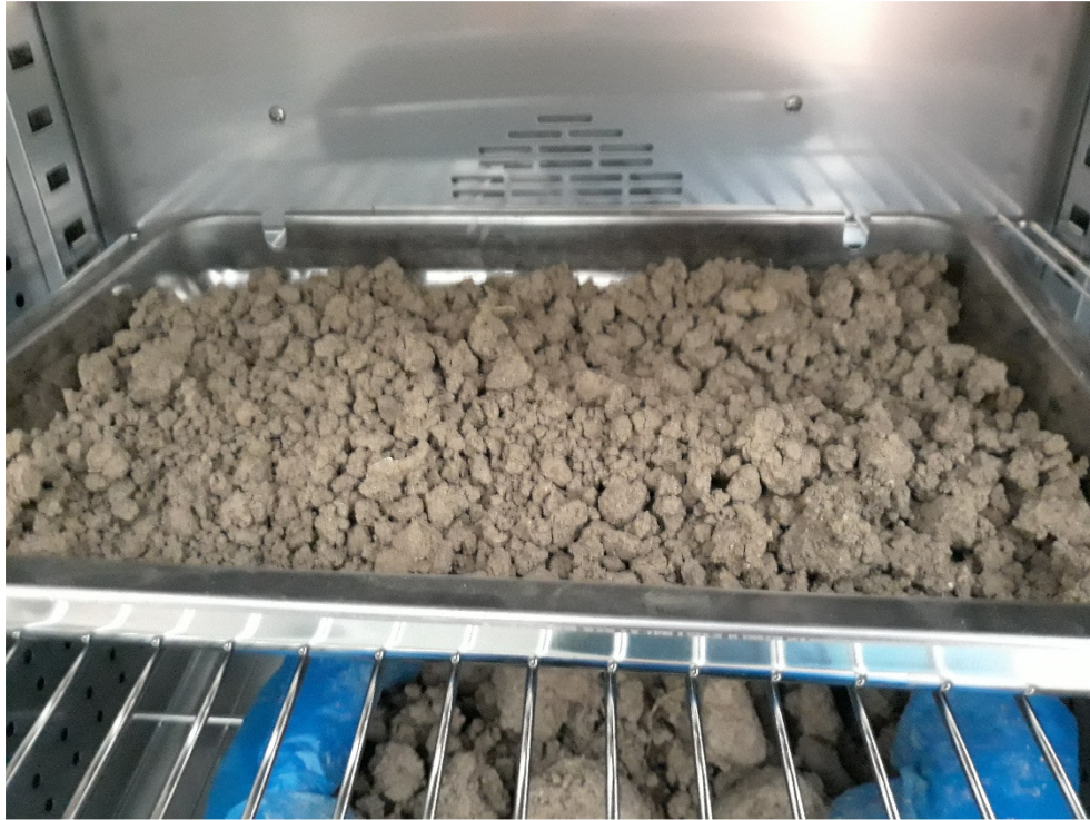
Εικόνα 5.12 Εισαγωγή των δειγμάτων στο φούρνο ξήρανης στους 33 βαθμούς Κελσίου.
