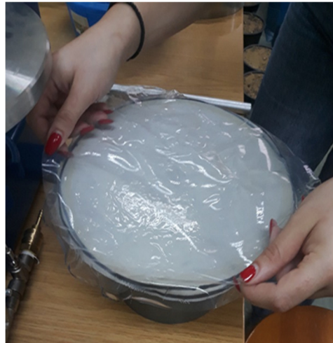
Εικόνα 5.18 Τα 2 φύλλα σελοφάν τοποθετούνται πάνω στην πλάκα και αφαιρούνται οι φυσαλίδες αέρα.
