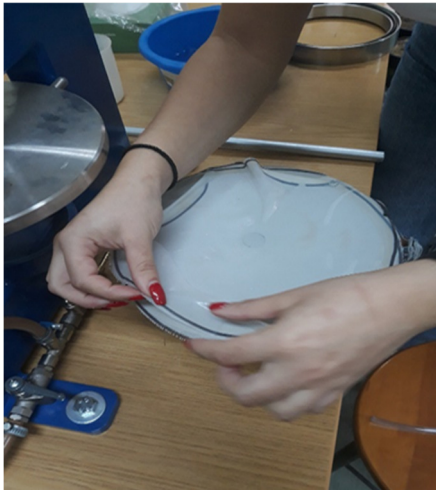
Εικόνα 5.17 Τα 2 φύλλα υφάσματος τοποθετούνται και αφαιρούνται οι φυσαλίδες αέρα.
