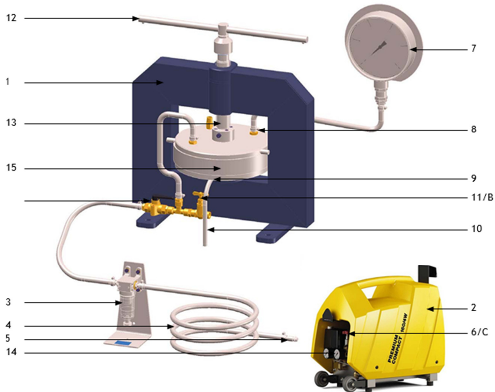
Εικόνα 5.2 Συσκευή Pressure Membrane Apparatus με αριθμημένα εξαρτήματα
